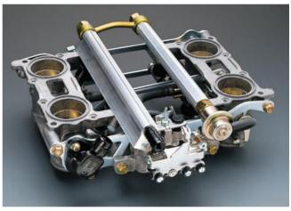
Sistema di alimentazione ad iniezione PGM-FI
